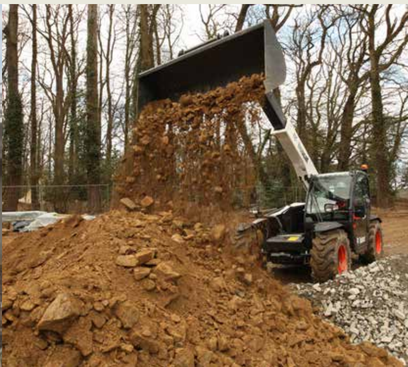
Ковши: для выемки грунта или перемещения легких материалов
