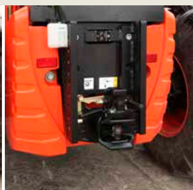
Поворотное тягово-сцепное устройство с регулировкой по высоте
